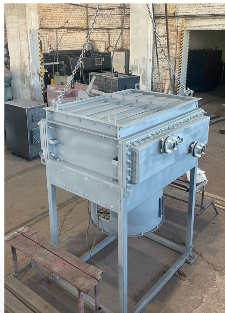
Аппарат воздушного охлаждения АВМ-Г-20-Ж-1,6-Б1-0,55кВт/ 4-4-0,75 УХЛ1 Выпуск февраль 2025 г.
